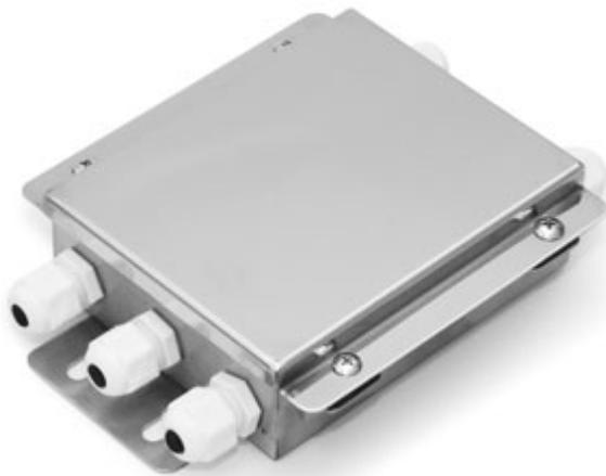
Scatola di giunzione in acciaio inox con grado di protezione IP65 da acqua e polveri, dotata di scheda elettronica per unione ed equalizzazione di 4 o 6 celle. Morsettiere a vite per agevolare il collegamento delle celle di carico e trimmer di regolazione del segnale, per una equalizzazione precisa ed affidabile.
