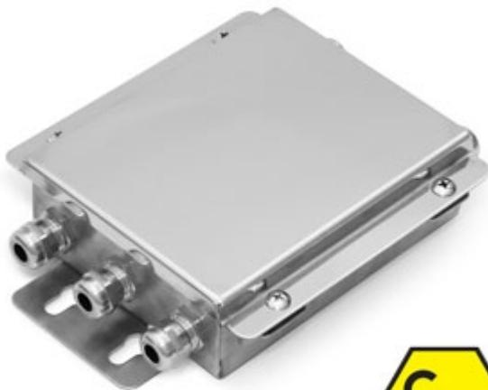
Scatola di giunzione in acciaio inox con grado di protezione IP66 da acqua e polveri, dotata di scheda elettronica a sicurezza intrinseca per unione ed equalizzazione di 1, 2, 3 o 4 celle. Morsettiere a vite per agevolare il collegamento delle celle di carico e trimmer di regolazione del segnale, per una equalizzazione precisa ed affidabile. Marcatura:
