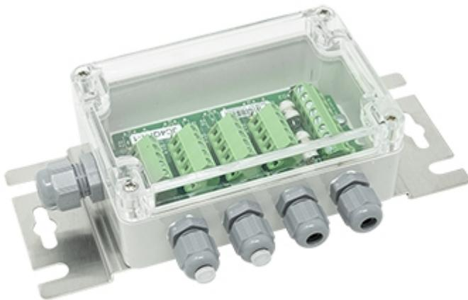
Scatola di giunzione IP67 a 4 ingressi specifica per ambienti esterni, permette di essere utilizzata come scatola di equalizzazione o di giunzione semplice di 2, 3 o 4 celle di carico. Morsettiere a vite per agevolare il collegamento e trimmer di regolazione del segnale, per una equalizzazione precisa ed affidabile. Il circuito di protezione protegge contro fulmini e sovratensioni.
