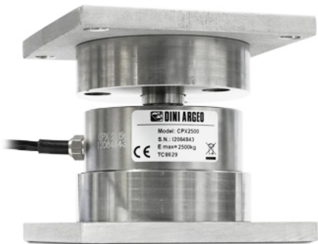
Grazie al kit componibile ELGO, è possibile installare rapidamente le celle di carico a compressione serie CPX fino a 12.500kg, per la pesatura di silos, cisterne, vasche o strutture in genere, contenendo i costi di installazione. Interamente in acciaio INOX ed estremamente semplice da pulire, ELGO è ideale per la pesatura in ambienti ostili o ad elevati requisiti d'igiene. Disponibile in versione ATEX per zone 1&21, 2&22.
