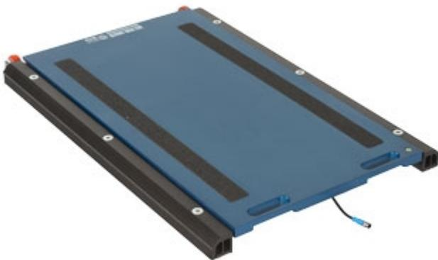
Piattaforme progettate per la realizzazione di stazioni pesa ruote e assi per veicoli di grandi dimensioni, dotati di ruote gemellate o pneumatici di grandi dimensioni (autotreni, autoarticolati, TIR, veicoli da cantiere etc.); munite di ruote integrate e maniglie per agevolarne il trasporto e il posizionamento. Particolarmente indicate per la pesatura dinamica.
